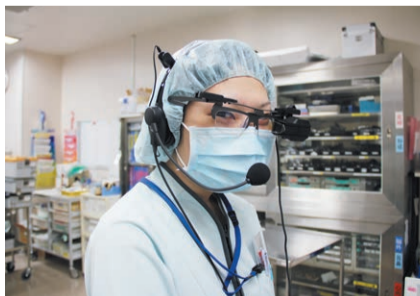
メガネに必要な情報が表示され、画面操作は音声で。手首につけたバーコードリーダーで、正しいものかどうかをチェック
